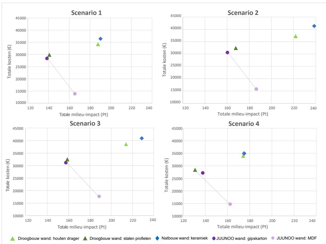
Fig. 4. Vergelijken van de totale kost samen met de totale milieupact van de binnenwanden met behulp van Pareto fronten (stippelijnen) voor de vier verbouwingsscenario's in de case woning in Berchem.
