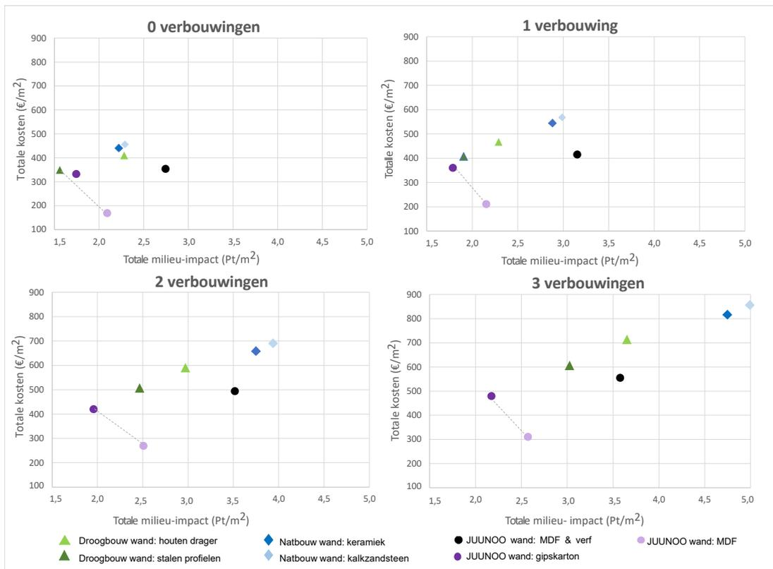
Fig. 3. Vergelijken van de totale kost samen met de totale milieupact van de binnenwanden met behulp van Pareto fronten (stippelijnen) voor de vier verbouwingfrequenties op element niveau.
